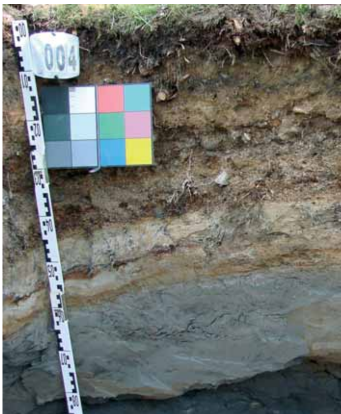
Ein Kalkgley mit einem C-Vorrat von 40 t C pro Hektar bis 90 cm Tiefe Foto: C. T. Aydin
