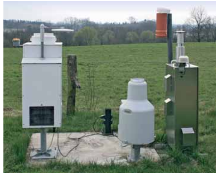
Messungen zum Stoffeintrag und zur Luftqualität auf der Freifläche der Level II Core-Fläche Bornhöved Foto: H. Meesenburg
