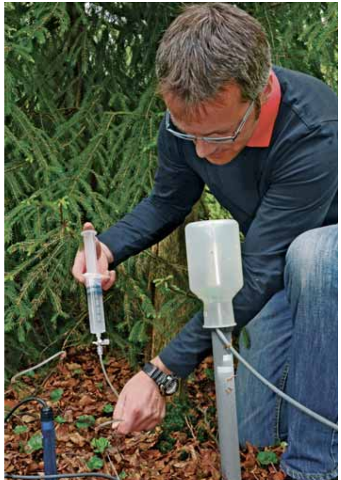
Wartung von Bodenfeuchtemessgeräten
