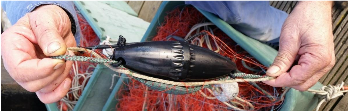
Abbildung 5: PAL-Befestigung an einer Stellnetzoberleine (Foto: Boris Culik)
