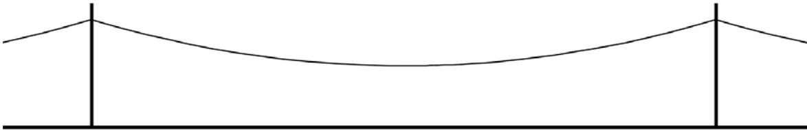
Durch die Wärme im Sommer verlängert sich das Kabelstück zwischen den beiden Masten.
