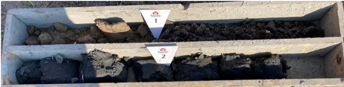
Abbildung 3-1: Bohrgut Auffüllung, KB 7 (0,0 – 2,0 m)
