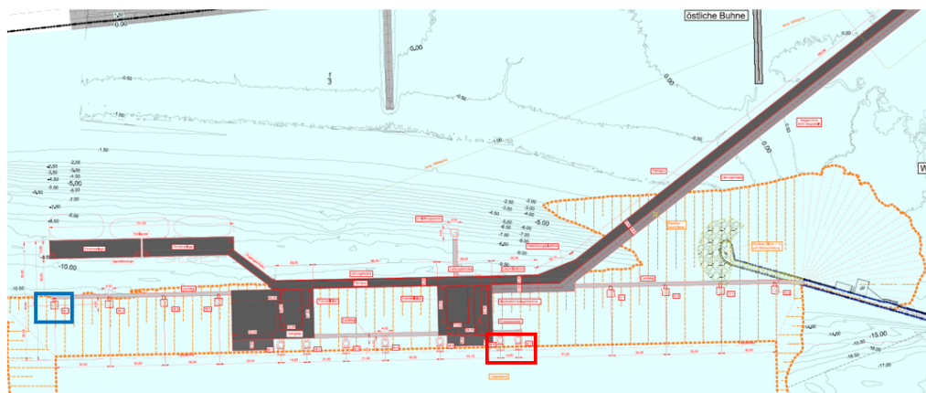
Abbildung 2.1: Layout des geplanten Anlegers im Westbecken. Die blau umrahmte Vertäudalbe und die rot umrahmten Anlegedalben wurden für die Bestimmung der Kolkbildung an Pfahlgruppen (Abschnitt 4.4) ausgewählt.
