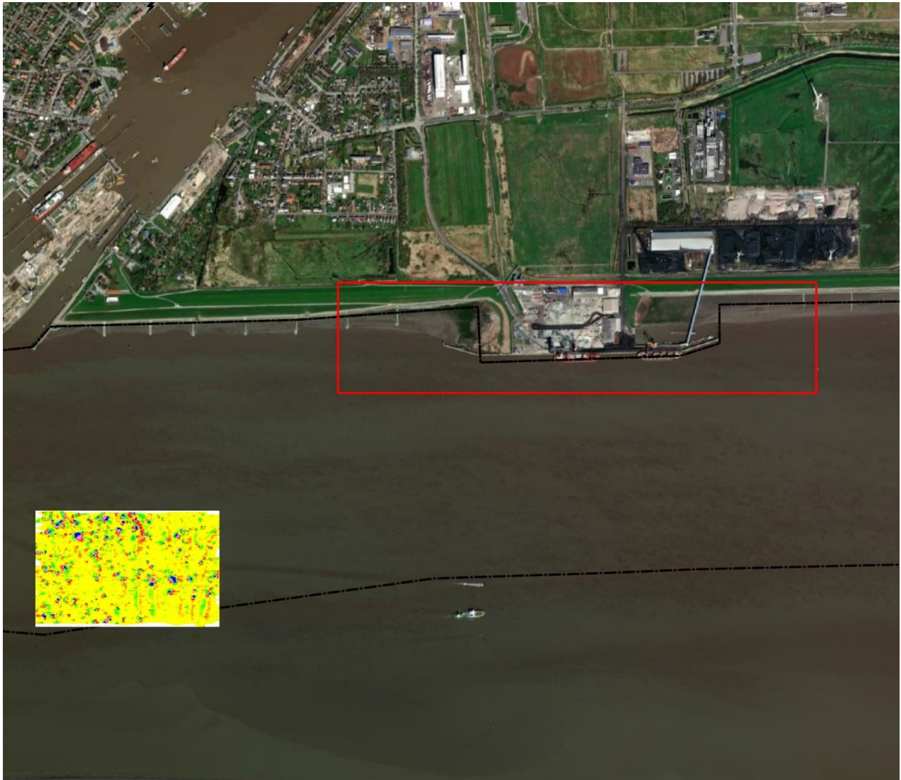
Abbildung 5: Sondierungsergebnisse Magnetik (2014) im Bereich des Hindernisses 859, einer mit Torpedos geladenen Schute, die in der Elbe bei Brunsbüttel gesunken ist.
