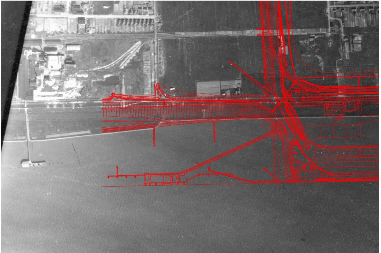
Abbildung 3: Projektgebiet FSRU Brunsbüttel überlagert auf das Kriegsluftbild vom 20.04.1945. Es sind landseitig im Projektgebiet und in dessen Umfeld keinerlei Bombardierungsschäden festzustellen.
