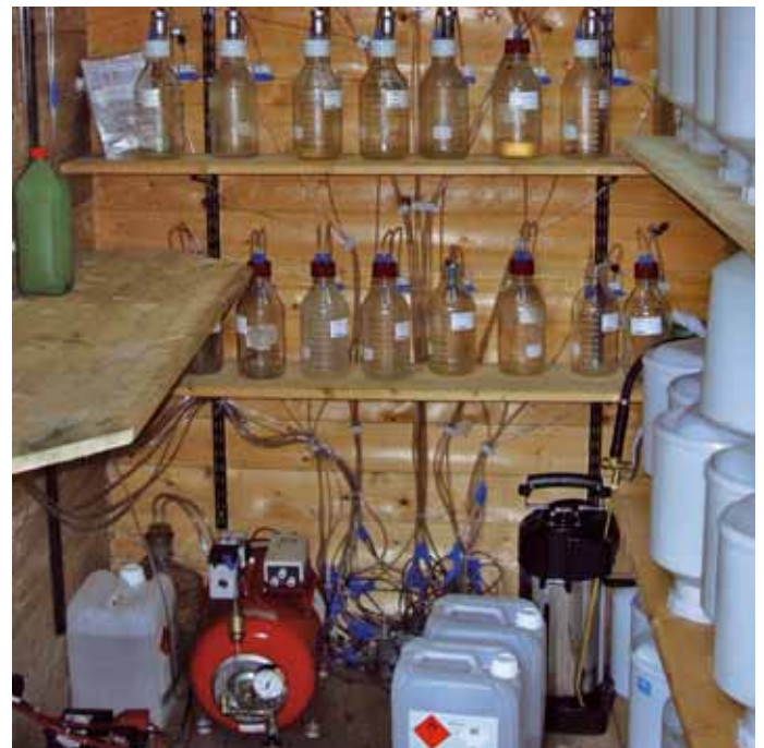
Mit Unterdruck wird Bodenlösung aus verschiedenen Bodentiefen gewonnen Foto: NW-FVA
